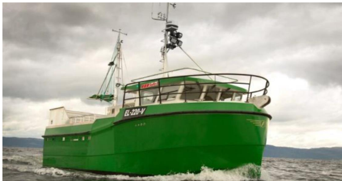
Figur 5: Hybrid-fiskefartøj i Norge, som sparer op mod 70% af CO 2 -udledningerne (EA Energianalyse, 2023a)
