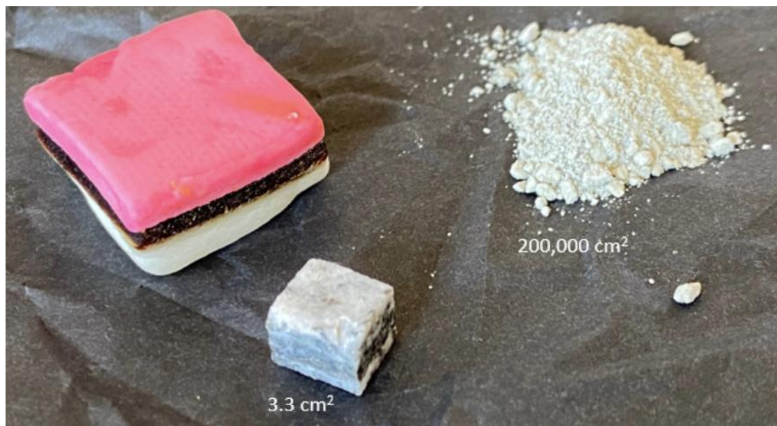
Figur 11: Gletsjermel (pulveret) har et meget højt overfladeareal. Den større kontaktflade er årsagen til, at reaktionen med CO 2 foregår hurtigere end på andre stens overflader.
